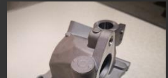
アルミニウム ダイカスト+ CNCマシニング
